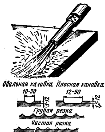
Рис. 72. Схема поверхностной кислородной резки и форма выплавляемых канавок
